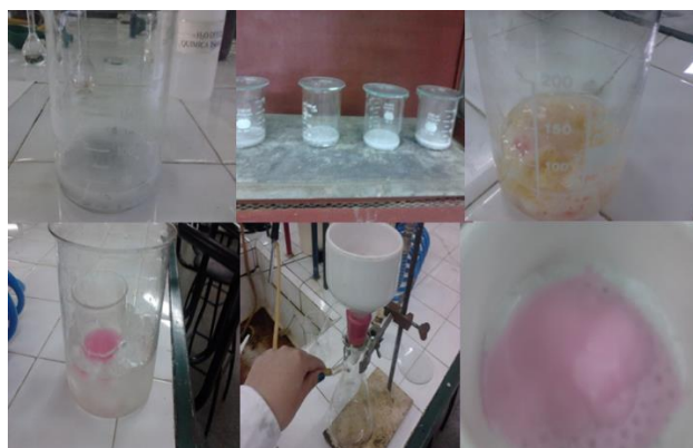
Figura 2. Etapas del desarrollo experimental. En la parte superior se pueden observar el proceso de disolución del aluminio y en la inferior el filtrado de los cristales.
