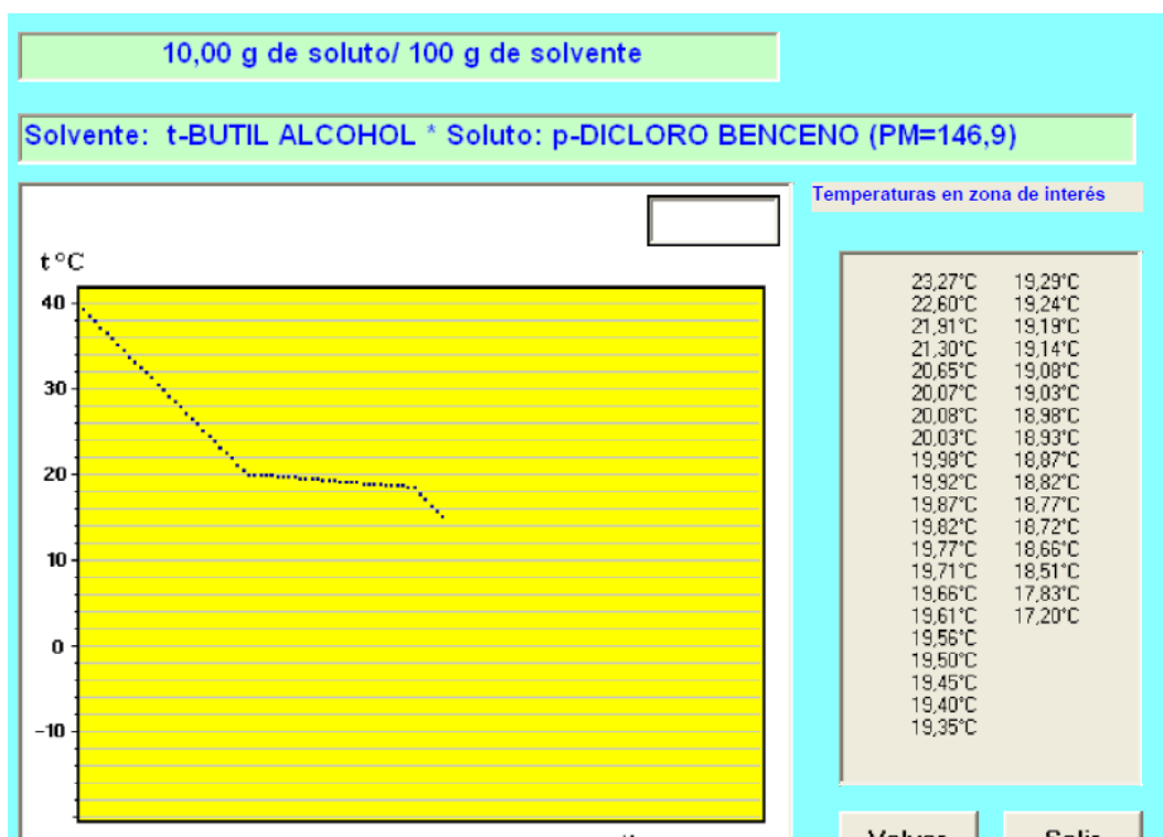
Figura 3.- Pantalla típica que muestra curva de enfriamiento
