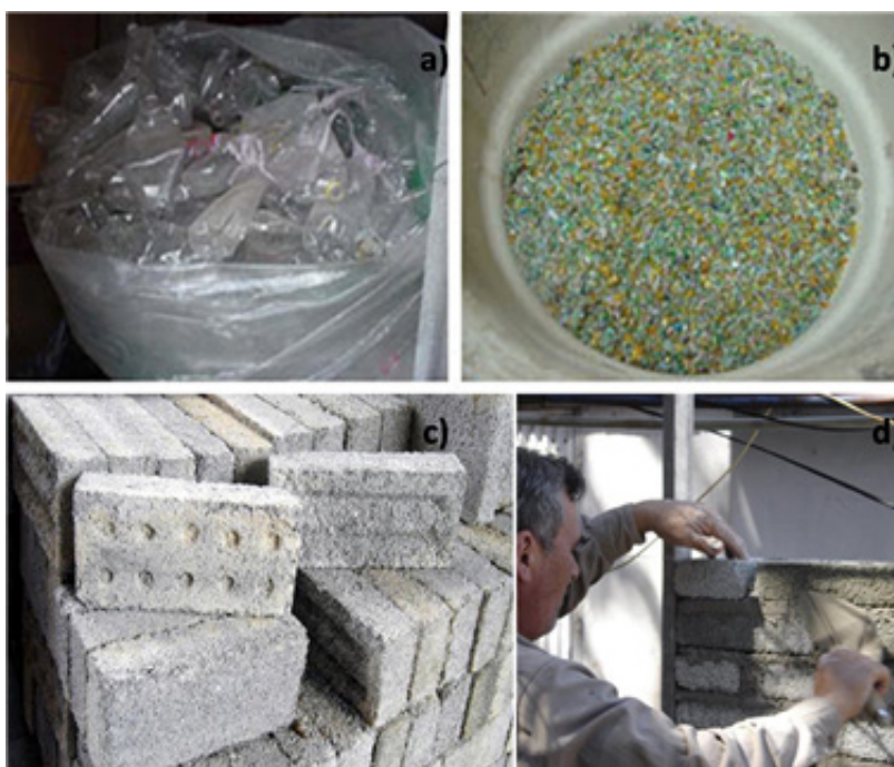
Figura 23: a) Botellas de PET recuperadas b) Triturado de botellas c) Ladrillos hechos de PET y aditivos d) Utilización en construcción.
