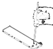
Fig. 5. Aplicación de la muestra en el cromatofolio.
