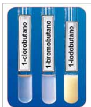
Figura 4. Resultados experimentales para la hidrólisis de haloalcanos en nitrato de plata etanólico y acuoso después de 15 minutos. El nitrato de plata produce un precipitado insoluble de un haluro de plata. El precipitado se forma primero con yodobutano indicando que el yodobutano se sustituye más rápido.
