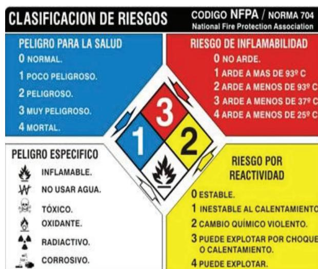
**Figura 4** – Diamante de Seguridad de la NFPA
