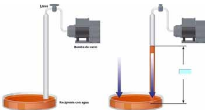
Figura 2: Efecto de hacer vacío en un largo tubo sumergido en un reservorio de agua. Se muestra la altura máxima alcanzada por el agua.
