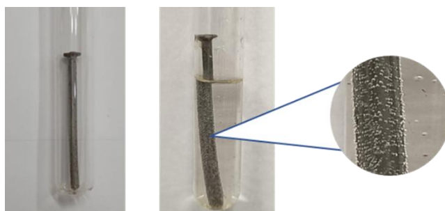
Figura 1. Ensayo 1: clavo de hierro (izquierda), clavo sumergido en solución de ácido clorhídrico (derecha)
