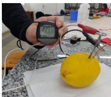
Figura 2. Ensayo 2: pila constituida por un limón, una barra de cobre, una barra de magnesio y un velocímetro
