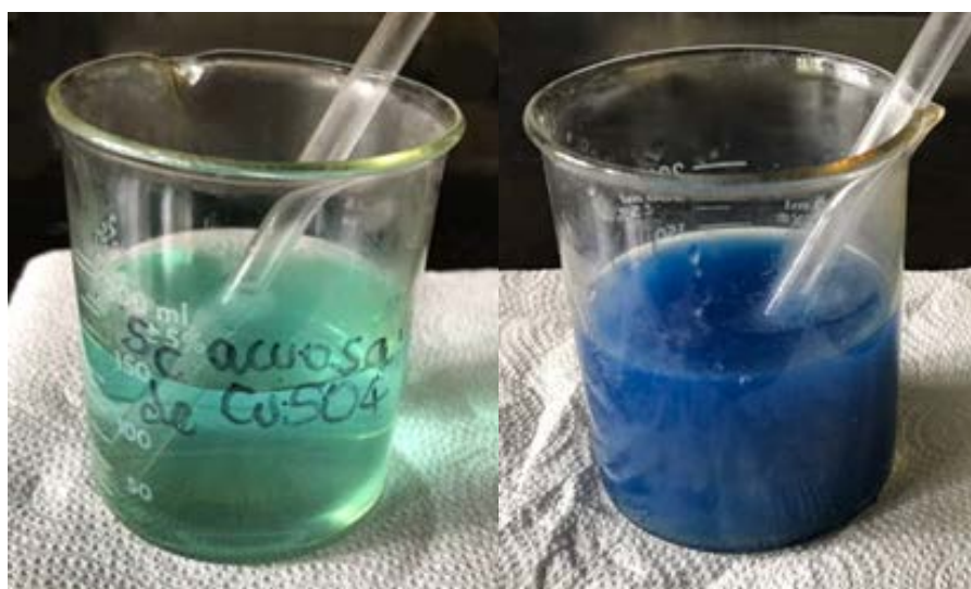
Figura 4. Solución de \text{CuSO}_4 (izquierda) y solución [\text{Cu}(\text{NH}_3)_2]\text{SO}_4 (derecha)
