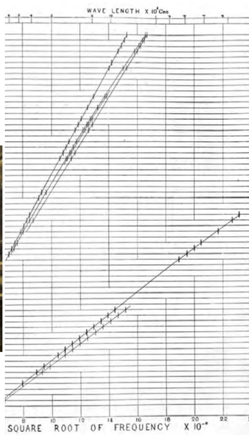
Figura 13. Fotografía de Moseley en el laboratorio Balliol-Trinity de la Universidad de Oxford (1910) y la representación de la raíz cuadrada de las frecuencias de emisión de rayos X de los elementos en relación a su número atómico, publicada en Philosophical Magazine (1914).
